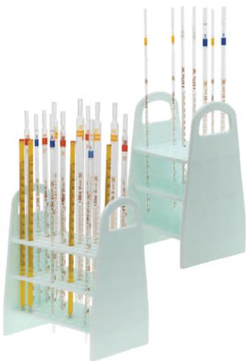
سازماندهی پیپت‌های معمولی ۵ تا ۲۵ میلی‌لیتری و پیپت‌های ژوژه ۷ تا ۵۰ میلی‌لیتری مناسب است. این استند از پلی‌پروپیلن ساخته شده، قابل اتوکلاو بوده و علاوه بر مقاومت در برابر اکثر اسیدها و حلال‌های رایج در آزمایشگاه، از ساختاری پایدار و استوار برخوردار است. از دیگر مزایای این استند، امکان باز و بسته شدن آن‌هاست که باعث صرفه جویی در فضای انبارش می‌شود.
