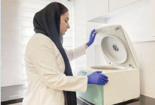
سانتریفوژهای P.I.T. به صورت رومیزی (benchtop) و با ارتفاع کم طراحی شده‌اند. این امر نه تنها بارگیری و تخلیه آسان روتور را تسهیل می‌کند، بلکه سبب می‌شود تمامی کاربران آزمایشگاه به راحتی بتوانند درب سانتریفوژ را باز و بسته کنند. درب این تجهیزات به راحتی قابل بسته شدن است که نه تنها باعث صرفه‌جویی در وقت شما در طول استفاده روزانه می‌شود، بلکه فشارهای مکرر را نیز از روی مچ شما برمی‌دارد.
