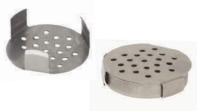
این کپسول از استیل ضد زنگ ساخته شده و قابل اتوکلاو است. روی کف و درب این کپسول تعداد زیادی حفره جهت تسهیل جریان سیال درون آن تعبیه شده است. در ب آن از نوع فشاری همراه با ۳ گیره می باشد. کپسول بافت فلزی در برابر اکثر اسیدها و مواد شیمیایی رایج در آزمایشگاه ها مقاوم است.
