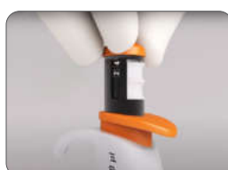
تنظیم حجم مورد نیاز با چرخاندن دکمه تنظیم
