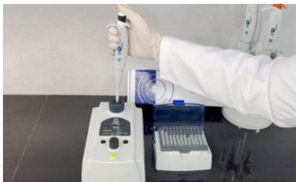
تست‌های عملکردی سمپلر از جمله تست نشتی
