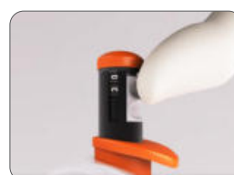
ثابت کردن حجم با دکمه Unlock / Lock
