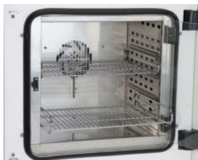
بدنه داخلی از جنس استیل ضد زنگ
