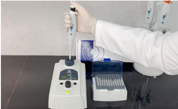
تست های عملکردی سمپلر از جمله تست نشتی
