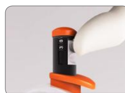
ثابت کردن حجم با دکمه Unlock / Lock
