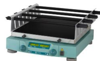
شیکر روتاتور با سینی قیف جداکننده
